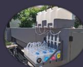
Sistema de fornecimento de tinta com pressão ajustável, para maior estabilidade em longas impressões.
